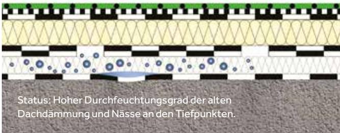
Status: Hoher Durchfeuchtungsgrad der alten Dachdämmung und Nässe an den Tiefpunkten.
