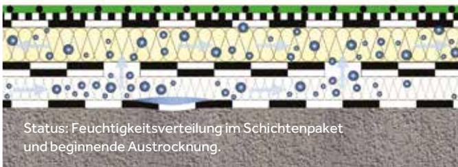
Status: Feuchtigkeitsverteilung im Schichtenpaket und beginnende Austrocknung.
