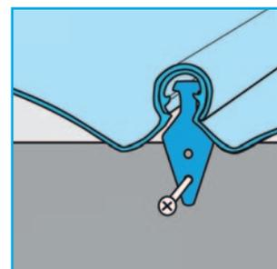
Jede Platte ist am oberen Rand mit einer zusätzlichen Schraube (Spenglerschraube mit Dichtung) zu befestigen.
