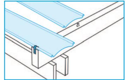
Erste Platte mit großer Wulst am Rand liegend auf Topclips drücken. Am Rand Seitenbeschlag setzen.
