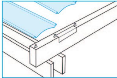
Erste Topclips am Rand aufbringen, weitere mithilfe der beigelegten Abstandshalter montieren.
