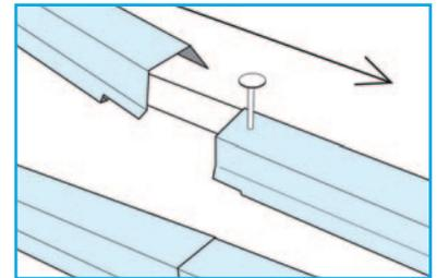
Zum Abschluss die Ortgangsprofile auf dem Windfangbrett verlegen.
