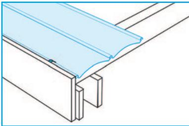
Weitere Platten mit großer Wulst auf kleine Wulst der zuvorverlegten Platte drücken. Anschließend kleine Wulst auf Topclips drücken.
