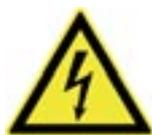
Dieses Symbol wird verwendet, wenn eine Gefahr des Kontaktes mit elektrischer Spannung besteht.
