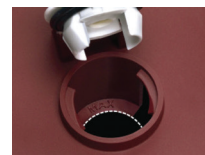
Eixo de ventilação com indicador de nível
