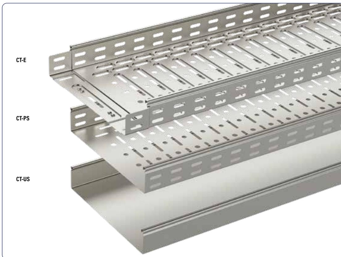
Ассортимент кабельных лотков СТ включает оцинкованные PG, горячеоцинкованные HDG, из нержавеющей стали HST, перфорированные (СТ-E и СТ-PS) и неперфорированные (СТ-US) лотки. Высотой борта - 35, 60, 85 и 110 мм, шириной - 50–600 мм, длиной - 3000 мм.
