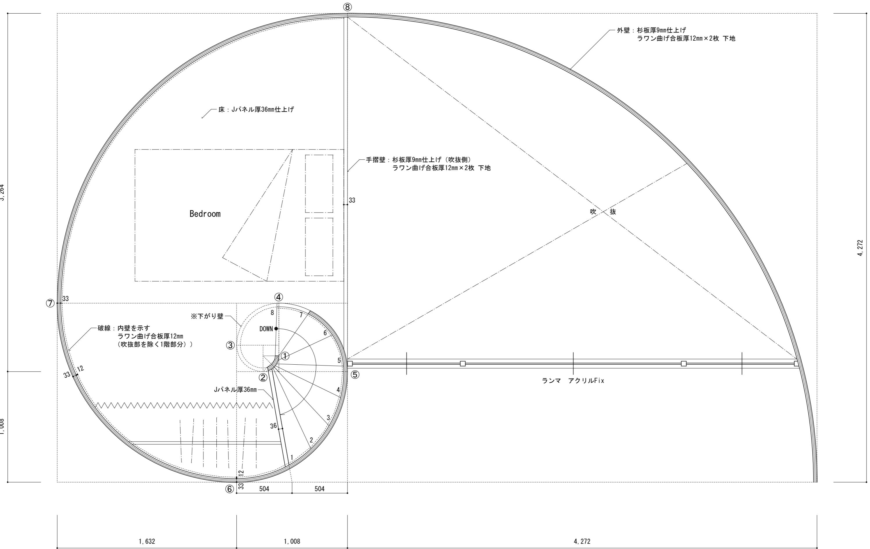
凡例) ①～⑧: フィボナッチ級数による円弧半径の境界位置を示す(展開図参照)
