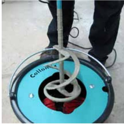
Den verschmutzten Rührer zwischen die Bürsten tauchen, dabei den Rührer langsam drehen lassen, bis vollständig eingetaucht.
