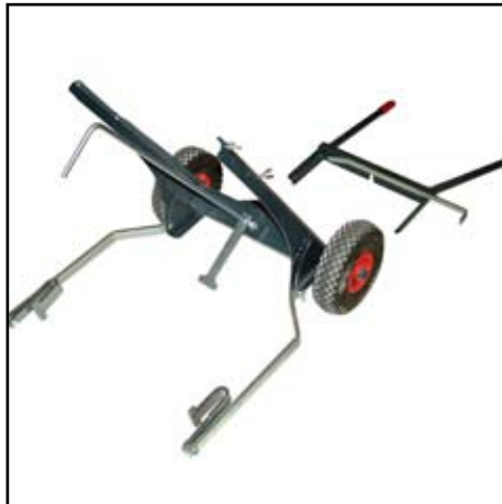
Lösen der Flügelschrauben, und Aufrichten der beiden Ausleger bis zum Anschlag, anschließend wieder die Flügelschrauben festziehen
