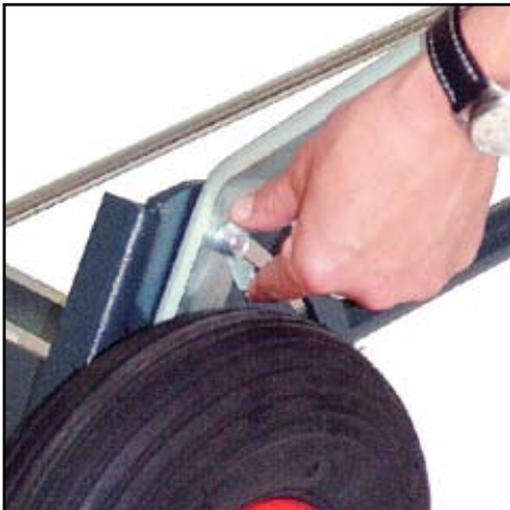
Wagen auf den Boden legen zum positionieren der Ausleger
