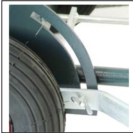
Lösen der Flügelschrauben, und Aufrichten der beiden Ausleger bis zum Anschlag, anschließend wieder die Flügelschrauben festziehen
