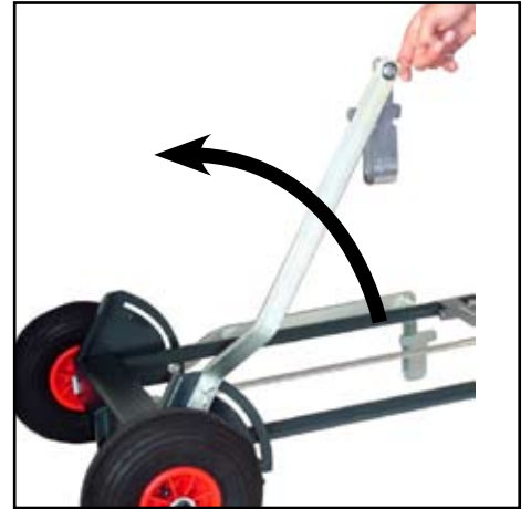
Lösen der Flügelschrauben, und Aufrichten der beiden Ausleger bis zum Anschlag, anschließend wieder die Flügelschrauben festziehen
