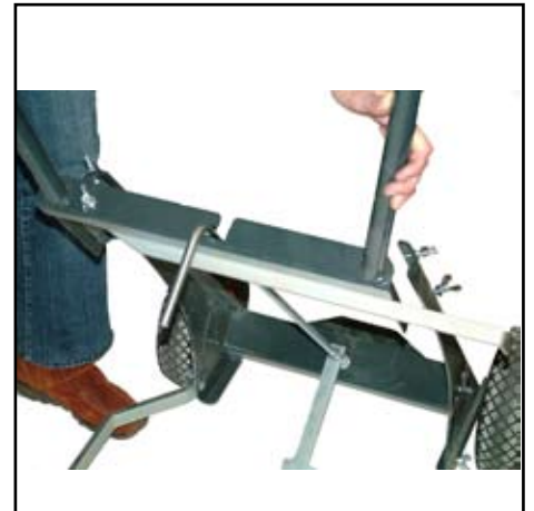
Das Griffteil mit den 4 Flügelschrauben befestigen
