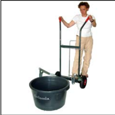
Um den Eimer hoch zu heben, pressen Sie einen Fuß gegen die Achse
