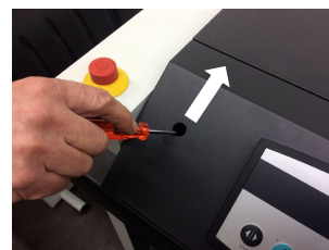
Déverrouillage de porte
