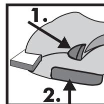
Apăsați comutatorul PORNIT/OPRIT (2).
