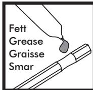
Maintenez le coupleur HEXAFIX propre et en bon état. Une fois le travail achevé, sortir le mélangeur du coupleur. Graissez régulièrement le logement hexagonal du coupleur avec une graisse lubrifiante adéquate.
