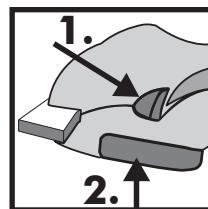
Pritisnite sklopku za UKLJUČIVANJE/ISKLJUČIVANJE (2).
