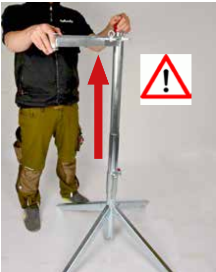
ACHTUNG: Federdruck drückt das Rohr schnell nach oben - Verletzungsgefahr!
