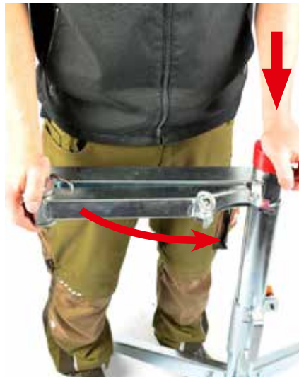
Das Rundrohr gedrückt halten und 4-Kant-Rohr zur Seite schwenken. Ist die Entriegelung gelöst, drückt die Federkraft den Schwenkarm nach oben
