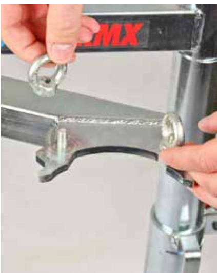
ACHTUNG: Federdruck drückt das Rohr schnell nach oben - Verletzungsgefahr!
