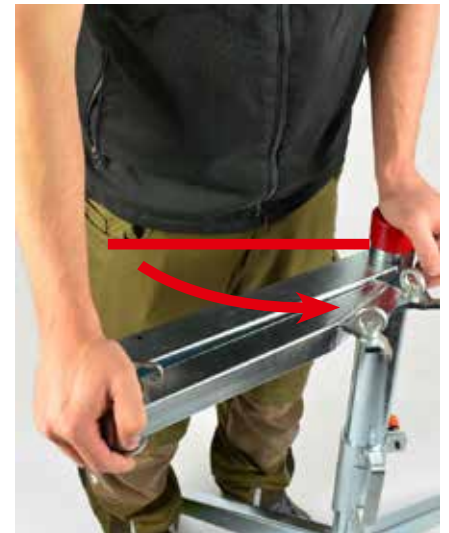
Das Rundrohr gedrückt halten und 4-Kant-Rohr zur Seite schwenken. Ist die Entriegelung gelöst, drückt die Federkraft den Schwenkarm nach oben
