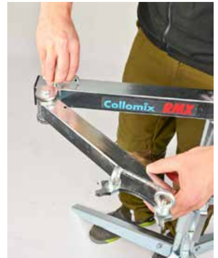
Das Rundrohr gedrückt halten und 4-Kant-Rohr zur Seite schwenken. Ist die Entriegelung gelöst, drückt die Federkraft den Schwenkarm nach oben
