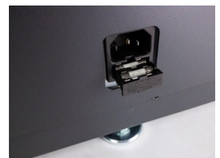
Fusible de la machine
