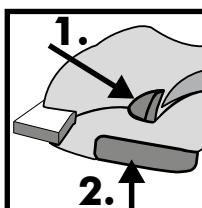
Придържайте винаги машината с две ръце. Натиснете бутона на блокировката срещу включване (1).
