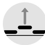
permette la rimozione facile e veloce delle doghe senza dover intervenire sull'intera pavimentazione
