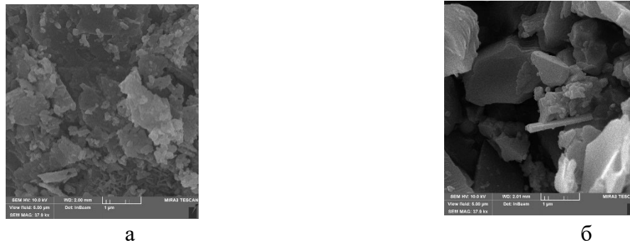
Рисунок 1. РЕМ-зображення вихідних прошків \alpha -Al 2 O 3 (а) та (BC+YSZ) (б)
