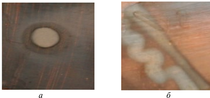
Рис. 2 Локальні покриття у вигляді: а) плями; б) ліній ( \times 20 )
