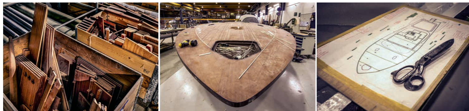
Genau nach Plan: Die Rümpfe der J Craft Torpedo entstehen aus GFK, Deck und Interior zierte meist Mahagoni. Die Eigner haben selbstverständlich eine Vielzahl an Gestaltungsmöglichkeiten. Auch der Rumpf lässt sich, für den besonders klassischen Look, mit dem rötlich glänzenden Tropenholz verkleiden.
