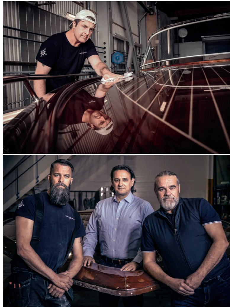
Spiegelnde Handarbeit: 18 Lagen Klarlack schützen das Mahagoniholz. Bootsbauer Niklas Jacobsson poliert, bis die Oberfläche perfekt glänzt (o. l.). Radenko Milakovic (u. M.) mit Bootsbaumeister Zoltan Antunovic (l.) und Werftchef Johan Hallén.
