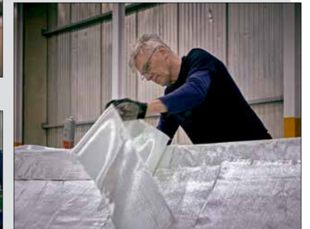
Les meilleurs tissus en vinylester sont sélectionnés avec soin, avant une stratification de la coque par infusion sous vide.
