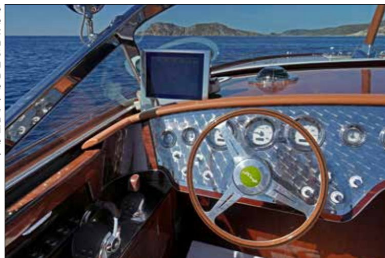
La pureté du style vintage a poussé JCraft à escamoter l'écran du traceur GPS dans un fourreau doté d'un mécanisme électrique. De même, l'instrumentation est aussi bien analogique que numérique.
