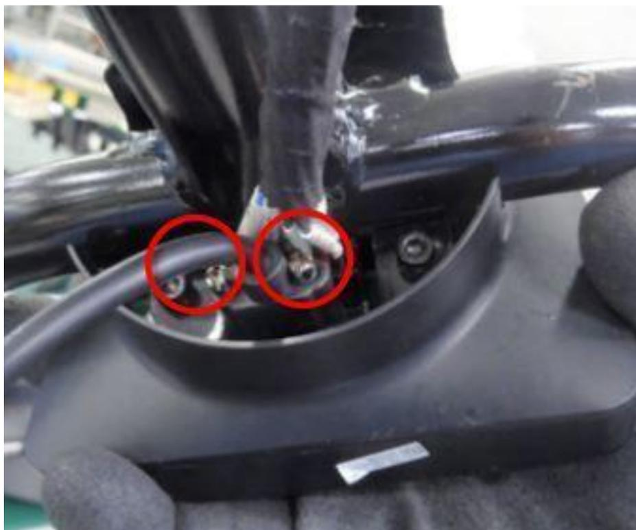
Löse die vier Inbusschrauben, die den Lenker und das DBC verbinden.
