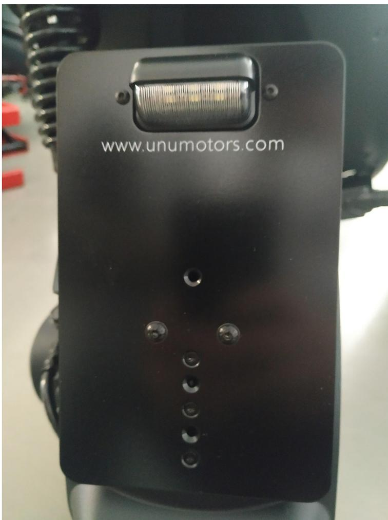
Löse die beiden kleinen Inbusschrauben, um die Kennzeichenbeleuchtung abzunehmen, wenn Du nur den Kennzeichenhalter selbst entfernen musst.
