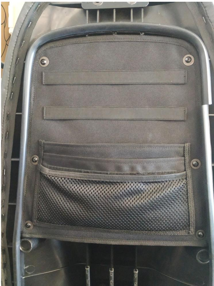
Das Stoffteil wird auf seine Metallstützplatte geschnallt und kann bei Bedarf einzeln ausgetauscht werden.
