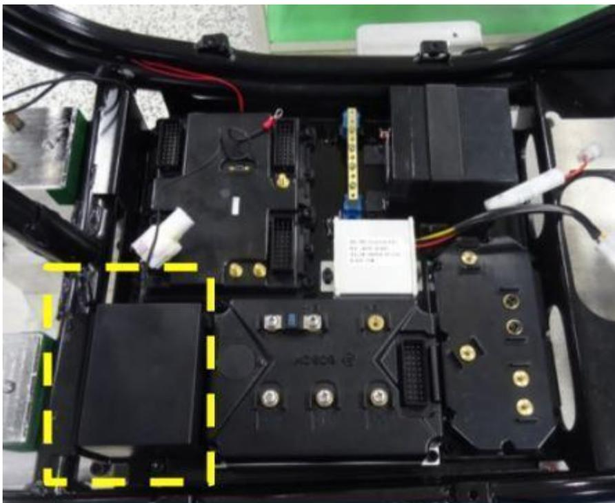
Löse die beiden Inbusschrauben, die die CB mit der Bodenplatte verbinden.
