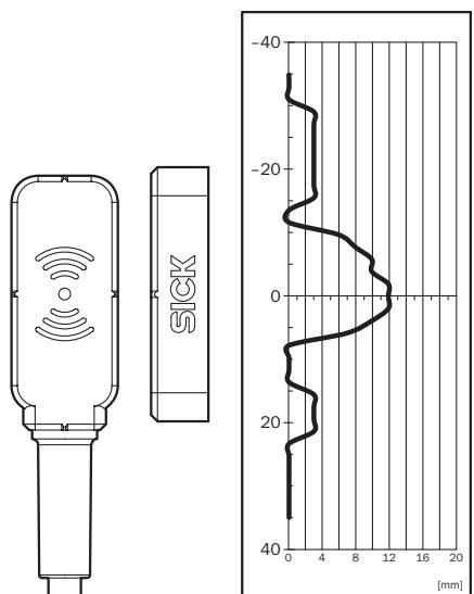
Gesicherter Einschaltabstand  $S_{ao}$  9 mm. Randbereiche bei paralleler Annäherung beachten: Wenn sich der Betätiger seitlich zur Sensorfläche bewegt, muss ein Mindestabstand von 4 mm (typisch) eingehalten werden. Dies verhindert ein zu frühzeitiges Auslösen aufgrund der seitlichen Ansatzbereiche.
