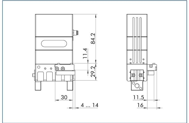
Der flexible Positionssensor FPS kann fünf frei programmierbare Bereiche bzw. Schaltpunkte für den Hub eines Greifers unterscheiden sowie in Verbindung mit einem PC als Messsystem benutzt werden.
