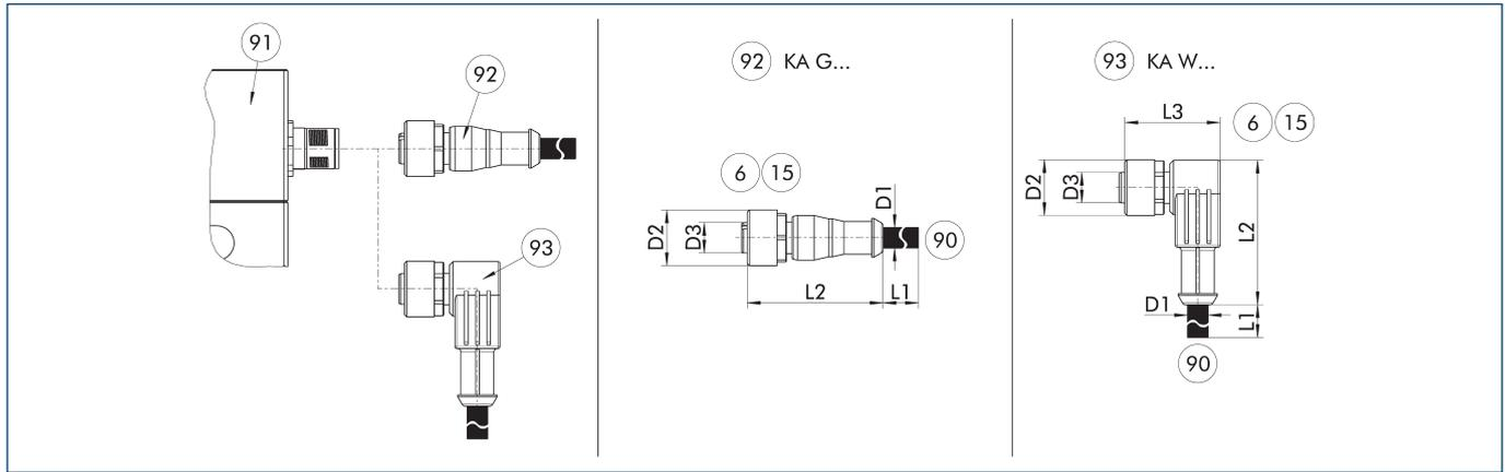
KA G... Anschlusskabel mit gerader Buchse
