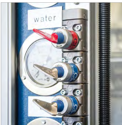
Gesicherter Zugang zu Anlagen mit persönlichem Schlüssel.
