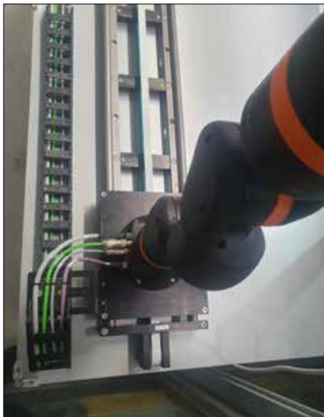
Abbildung 4: Ausrichtung Energiekette Diagram 4: Energy chain alignment
