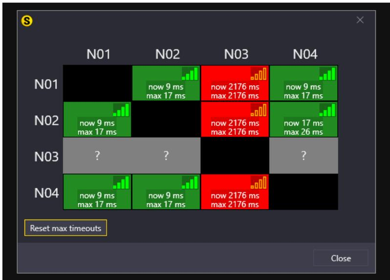
Figure 11.11 Kommunikationsdiagnose, bei der Knoten 3 spannungslos ist.
