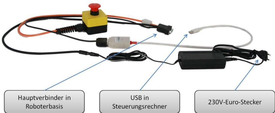
Abb. 2: Kabelbaum mit Netzteil und USB-Adapter
