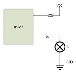
Figure 20. PNP output wiring diagram
