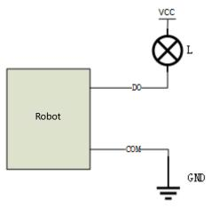
Figure 19. NPN output wiring diagram
