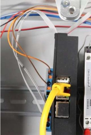
Das 2-adrige Flachbandkabel des integrierten Computers ist der RS232-Anschluss für das Handbediengerät. Eine Ader ist schwarz markiert (Ader 1).
