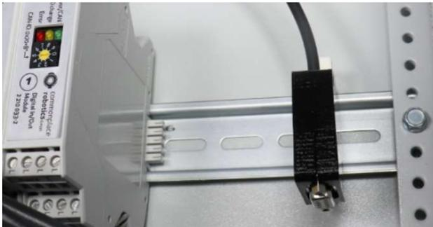
Abb. 4.7: D-Sub-Anschluss für das Handbediengerät
