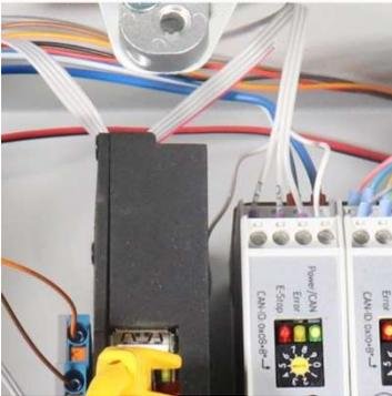
Das 3-adrige Flachbandkabel des integrierten Computers ist der CAN-Anschluss. Es hat eine schwarz markierte Ader (Ader 1, GND). Die Adern 2 und 3 sind CAN-L und CAN-H.
