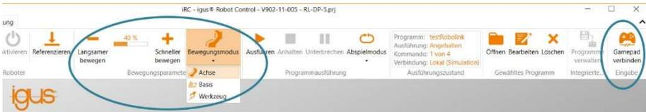
Abb. 7.5 Bedienfelder zum Bewegen des Roboters (blau markiert).
