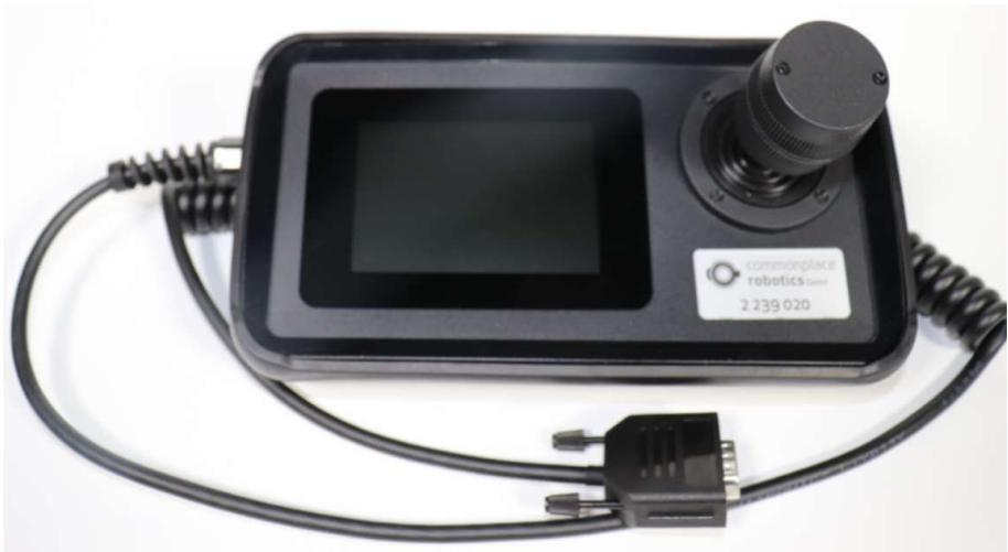
Abb. 4.8: Handbediengerät mit Touchscreen und 3-Achsen-Joystick.
