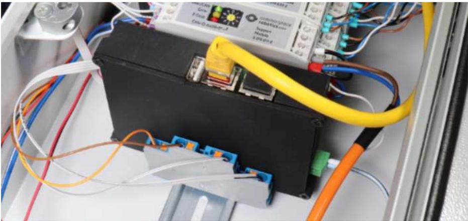
Abb. 4.6 Integrierter Computer mit Ethernet-Kabel, das an die ETH0-Buchse angeschlossen ist.
