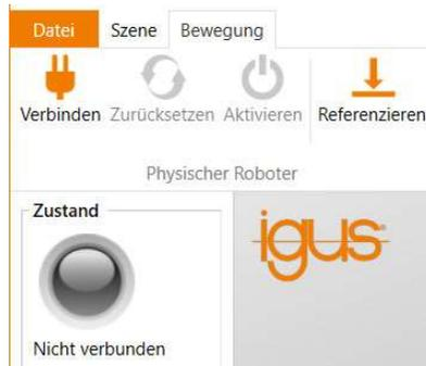
Abb. 7.3 Symbole für die Verbindung mit der Hardware, das Zurücksetzen von Fehlern und die Aktivierung der Motoren, Referenzierungssymbol und „Status“-Anzeige.
