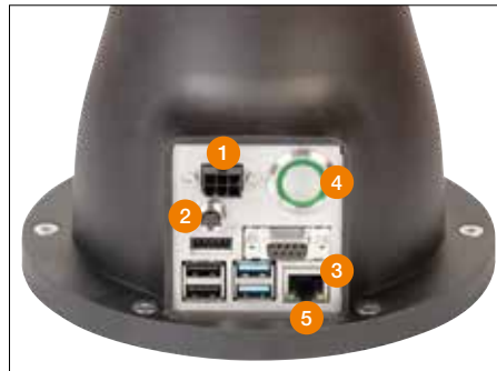
Bild 1: Basis-Anschlüsse des ReBeL® (mit Nummerierungs-Beispiel)
