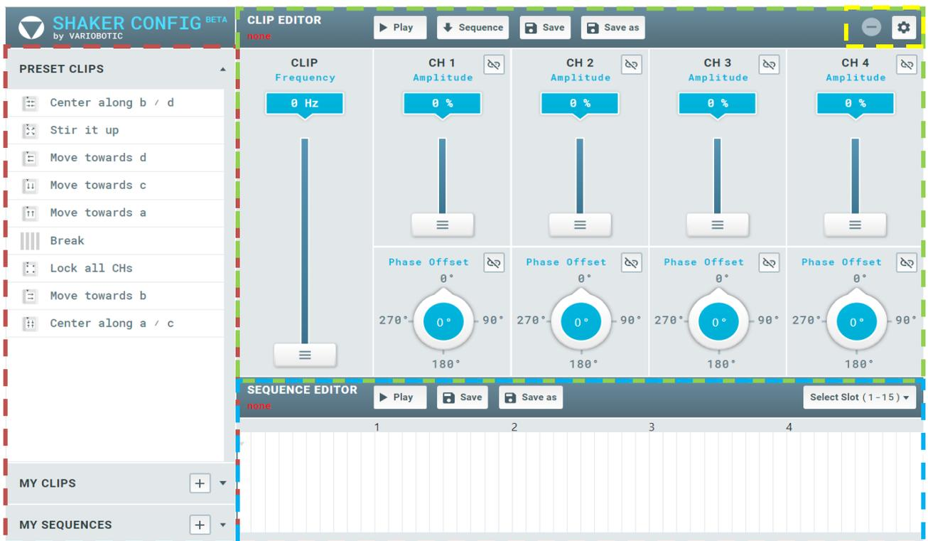
Abbildung 6.1: Bedienoberfläche VarioShaker
