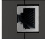
Die Belegung des Ethernet-Ports X8 entspricht der Standard-Belegung nach TIA-568A/B.
