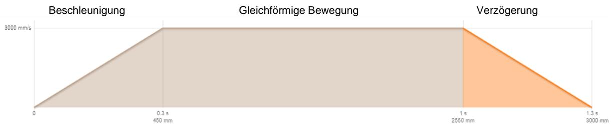
Bei einer Abwärtsbewegung tritt der Generatorbetrieb während der Verzögerungsphase und in reduzierter Intensität auch während der gleichförmigen Bewegung auf.
