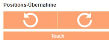
8. Fahren Sie den Schlitten mit den Buttons der Positionsübernahme nun möglichst weit. Messen Sie erneut den Abstand des Schlittens zum Achsende.
