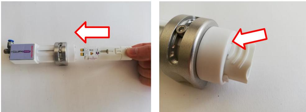
Setzen Sie den Modulträger auf das Treibergehäuse auf, in dem Sie ihn oberhalb der Schnittstelle flächig ansetzen und dann bis zum Anschlag herunterdrücken.
