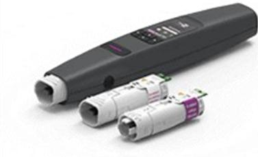
Der piezobrush® PZ3 ist als kompaktes Plasma-Handgerät für den Einsatz in Laboren, der Vorentwicklung und der Montage von Kleinserien entwickelt worden. Bei einer maximalen Leistungsaufnahme von 18 W wird mithilfe der Piezoelectric Direct Discharge (PDD®) Technologie kaltaktives Plasma mit einer Temperatur von weniger als 50°C erzeugt.
