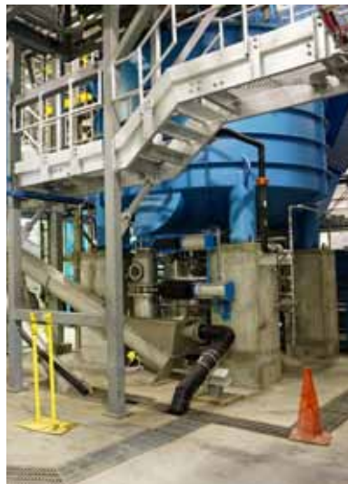
Digestori (levo) i BTA pulper za otpad (desno). Varen, Kanada.
