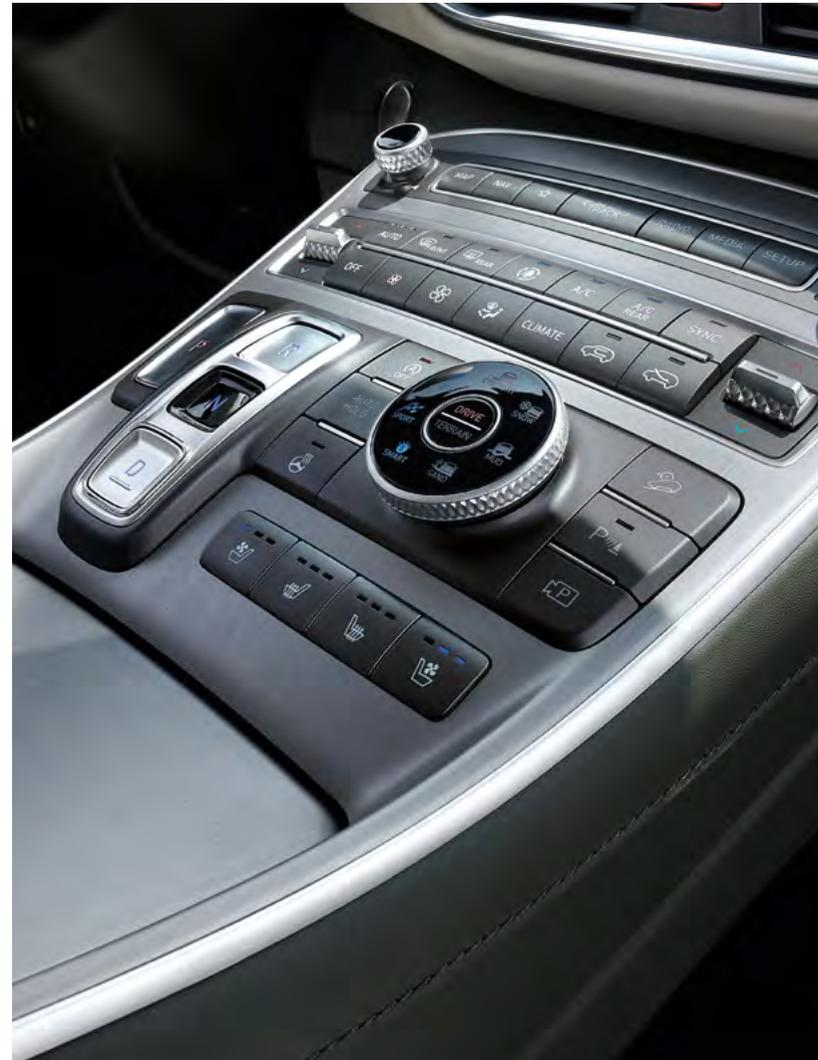
Schwabende Mittelkonsole und Shift-by-Wire (elektronische Steuerung der Gangwahl)
