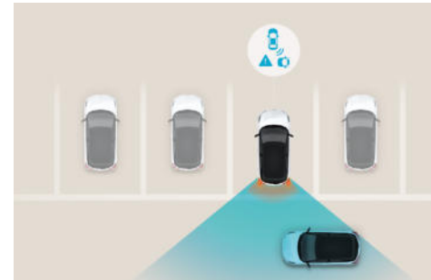
Querverkehrswarner hinten (RCCA) Beim Rückwärtsfahren aus Bereichen mit schlechter Sicht warnt Sie der Querverkehrswarner vor seitlich heranfahrenden Fahrzeugen.
