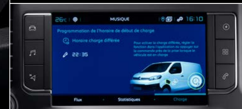
PROGRAMMIERTE LADUNG: Sie können den Zeitpunkt für den Ladevorgang nach Ihren Wünschen einstellen.
