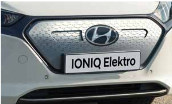
Im Kühlergrill integrierte Luftklappen öffnen und schließen sich automatisch, um die Aerodynamik und Kühlung bei allen Modellen zu optimieren.
