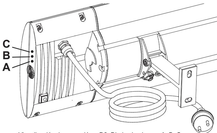
Visualización de operación a D2: Diodos luminosos A, B, C
