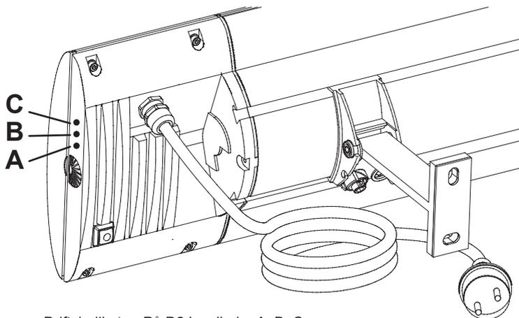
Driftsindikator: På D2 Lysdioder A, B, C
