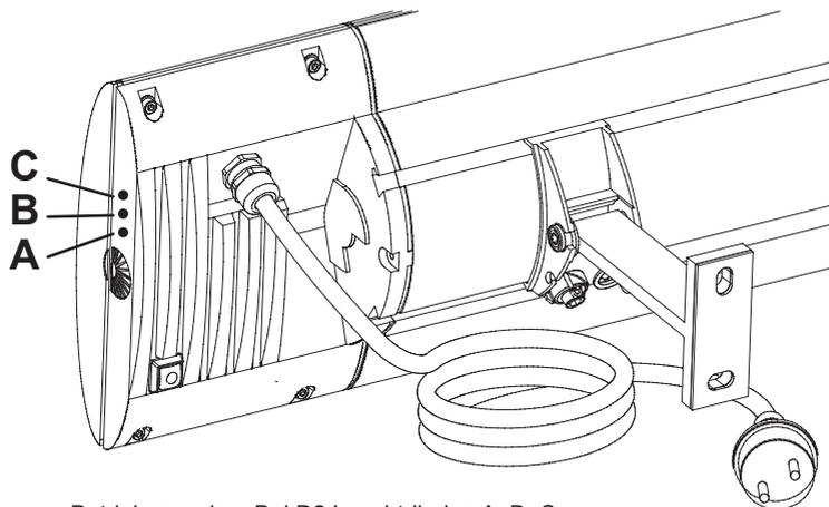
Betriebsanzeige: Bei D2 Leuchtdioden A, B, C
