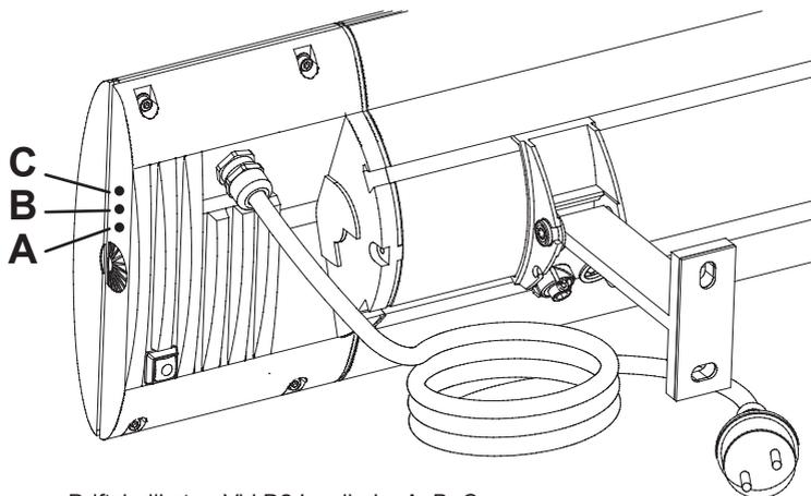
Driftsindikator: Vid D2 Lysdioder A, B, C
