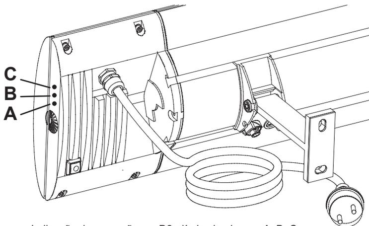
Indicação de operação: no D2: díodos luminosos A, B, C
