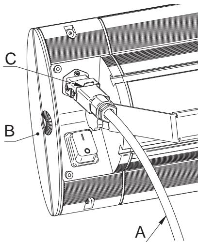
Modelos que no tengan interruptor empiezan a calentar inmediatamente después de conectar el enchufe a la red eléctrica. En los modelos con interruptores o radiorreceptores se activa la potencia calorífica activando el interruptor o mediante el mando a distancia.
