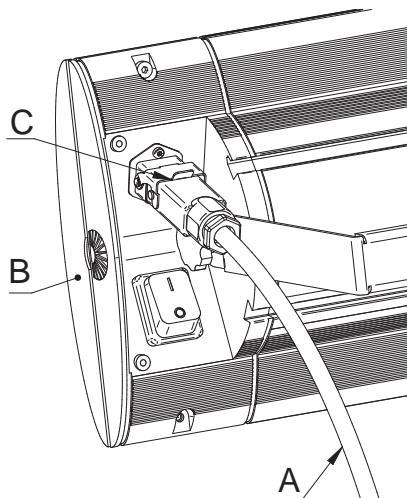
Bij modellen zonder schakelaar geschiedt het verwarmen onmiddellijk bij het insteken van de stekker in het stopcontact. Bij de modellen met schakelaar of draadloze ontvanger wordt het verwarmen door bediening van de schakelaar of de afstandsbediening geactiveerd.
