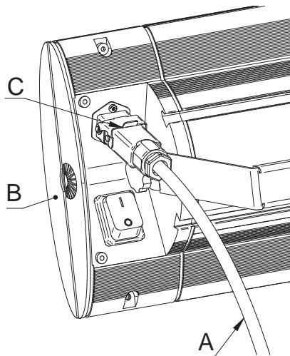
Nei modelli senza interruttore la produzione di calore si avvia subito dopo aver inserito la spina nella presa di corrente. Nei modelli dotati di interruttore o di ricevitore radio la produzione di calore inizia dopo aver premuto l'interruttore o azionato il telecomando.
