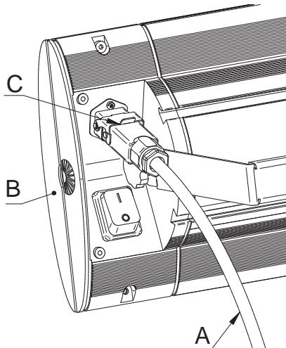
Pri modeloch bez spínača sa uskutoční vyhrievací výkon okamžite po zapojení sieťovej zástrčky do zásuvky. Pri modeloch so spínačom alebo rádiovým prijímačom sa aktivuje vyhrievací výkon stlačením spínača, resp. diaľkového ovládania.
