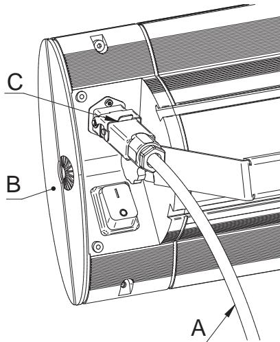
Ilman kytikintä olevissa malleissa i lämmityssuoritus seuraa heti verkkopistokkeen pistorasiaan sisäänlaiton myötä. Malleissa, joissa kytkin tai radiovastaanotin aktivoi lämmitystehon käytämällä kytikintä tai kaukokäyttöä.
