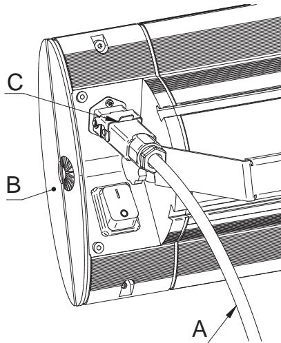
På modeller uten bryter starter oppvarmingen med en gang støpslet plugges inn i stikkontakten. På modeller med bryter eller trådløs mottaker starter oppvarmingen når brytere trykkes hhv. fjernkontrollen aktiveres.
