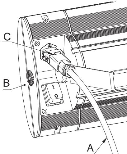
Bei Modellen ohne Schalter erfolgt die Heizleistung sofort mit dem Einsticken des Netzsteckers in die Steckdose. Bei den Modellen mit Schalter oder Funkempfänger wird die Heizleistung durch die Betätigung des Schalters bzw. der Fernbedienung aktiviert.
