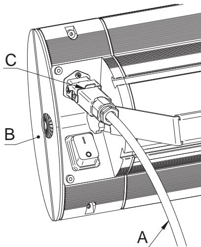
No caso de modelos sem interruptor ocorre imediatamente a potência de aquecimento com a conexão da ficha de rede na tomada. No caso de modelos com interruptor ou receptor de rádio, a potência de aquecimento é activada pela activação do interruptor ou do comando à distância.
