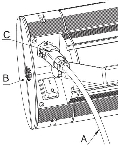
På modeller utan brytare startar värmedriften direkt när elkontakten sätts i eluttaget. På modeller med brytare eller radiomottagare startas värmedriften genom att aktivera brytarna eller med fjärrkontrolen.
