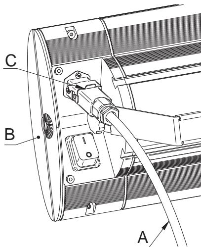
Pour les modèles sans interrupteur, la puissance de chauffage se déclenche directement lorsque la fiche est branchée dans la prise. Pour les modèles avec interrupteur ou récepteur radio, la puissance de chauffage est activée par actionnement de l'interrupteur ou de la télécommande.
