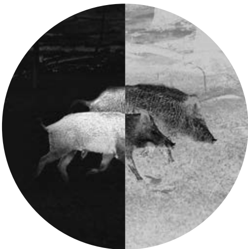
A hőképek két megjelenítési módja: bal oldalon fehér kiemelt (a hőforrások fehérek), jobb oldalon fekete kiemelt (a hőforrások feketék)
