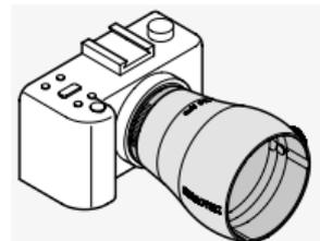
Okulari durбина SWAROVSKI OPTIK AT i ST 80 mehanički mogu da se spoje sa priključkom sa bajonetom na telima modela ATS/STS i ATM/STM 65/80. Međutim, najbolja optička slika se obezbeđuje ako se koriste okulari iz nove serije. Pretvorite svoj durbin u teleobjektiv korišćenjem SWAROVSKI OPTIK adaptera za digitalne foto-aparate.
