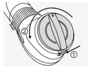
Da biste uklonili poklopac, kliznite mehanizam za zaključavanje okulara prema dolje i okrenite zaštitni poklopac ulijevo (u smjeru suprotnom od kazaljke na satu).
