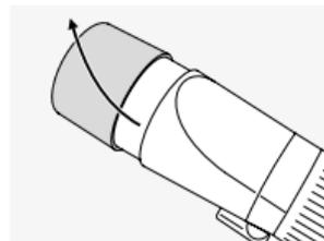
Integrirani, izduženi štitić za sunce sprečava da ometajuće bočno svetlo uđe i štiti objektiv od kiše.
