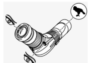
Nakładany celownik ma za zadanie pomóc w ustawieniu lunety obserwacyjnej na obserwowanym obiekcie.
