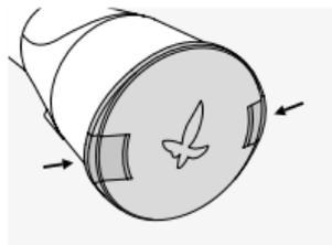
Для того, чтобы снять крышку нажмите одновременно на две пружины по торцу крышки.
