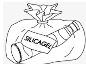
Teleskop můžete skladovat na dobře větraném chladném místě. Pokud dojde k namočení teleskopu, nechte jej nejdříve vyschnout. V tropických oblastech nebo oblastech s vysokou vlhkostí bude nejlepší, pokud budete zařízení skladovat ve vzduchotěsné nádobě společně s činidlem pohlcujícím vlhkost (např. silikagelem).
