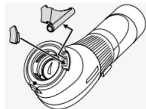
Ak namontovanú pomôcku na mierenie nepotrebujete, vytiahnite ju a vložte dodaný kryt.
