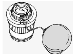
Capacul de protecție al ocularului este atașat de ocular cu un cordon rotund. Dacă slăbiți șurubul de pe ocular cu o șurubelniță, puteți scoate cordonul rotund cu capacul de pe ocular. Reintroduceți șurubul.
