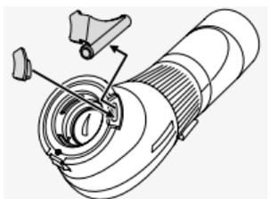
Če nameščenega pripomočka za ciljanje ne potrebujete, ga izvlecite in vstavite priložen pokrov.
