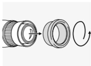
Az eszköz minden alkotóelemét és felületét úgy alakítottunk ki, hogy csekély ápolást igényeljen. A teleszkóp optikai tökéletességének hosszú távú megőrzése érdekében védje az üvegfelületeket a szennyeződéstől, olajtól és zsírtól. A lencsék tisztítása során először távolítsa el a durvább szennyeződések a lencsetisztító ecsettel. Az ez utáni alapos tisztítás érdekében azt
