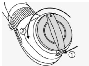
Для снятия крышки сдвиньте вниз фиксатор окуляра на корпусе, а крышку с байонетным затвором поверните влево (против часовой стрелки).
