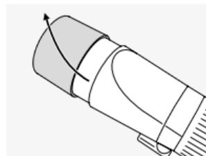
Zintegrowana, wysuwana osłona przeciwsłoneczna chroni przed utrudniającym obserwację światłem bocznym i zabezpiecza obiektyw przed deszczem.
