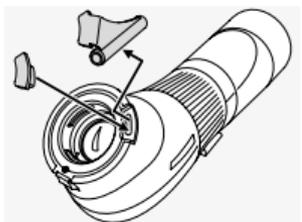
Jestliže nepotřebujete namontovanou zaměřovací pomůcku, vytáhněte ji a vložte dodaný kryt.
