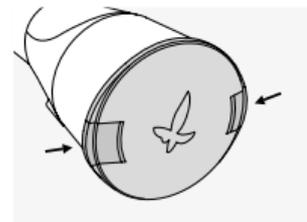
Za odstranitev pokrovčka stisnite izstopajoča zaskočna elementa na robu pokrovčka.
