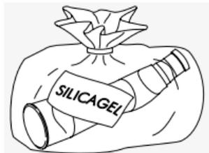
Teleskop by ste mali skladovať na dobre vetranom a tmavom mieste. Ak je teleskop mokrý, musí sa najskôr vysušiť. V tropických oblastiach alebo oblastiach s vysokou vlhkosťou odporúčame zariadenie skladovať vo vzduchotesnej nádobe spoločne s činidlom pohlcujúcim vlhkosť (napr. silikagélom).
