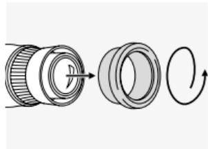
Vse elemente in površine smo zasnovali tako, da potrebujejo zelo malo vzdrževanja. Če želite zagotoviti trajno čist pogled skozi daljnogled, pazite na to, da steklene površine ne bodo umazane ali mastne. Ob čiščenju leč najprej s čopičem za leče odstranite večje delce. Za naknadno natančno čiščenje priporočamo, da dahnete na površino leče, da nastane kondenzirana plast, in lečo potem očistite z mehko, vlažno krpo.
