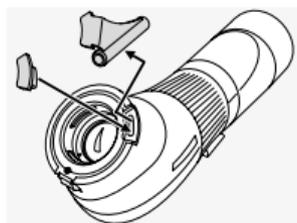
Jeżeli nakładany celownik nie jest potrzebny, należy go wyjąć i umieścić na jego miejscu osłonę dołączoną do lunety.
