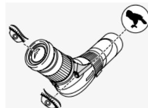
Указанное устройство предназначено для облегчения наводки зрительной трубы на объект.
