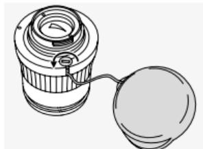
Pokrywka ochronna na okular jest przymocowana sznurkiem do okularu. Sznurek wraz z pokrywką ochronną można odczepić od okularu, poluzowując śrubokrętem wkręt w okularze. Wkręt należy następnie dokręcić.
