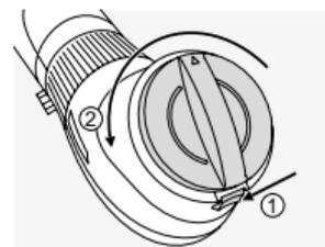
Aby zdjąć osłonę, przesun w dół mechanizm blokujący okularu i obróć osłonę w lewo (przeciwnie do kierunku ruchu wskazówek zegara).
