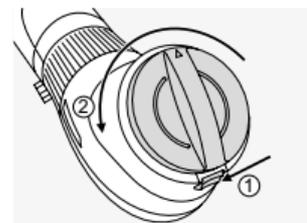
A tok eltávolításához csúsztassa lefelé a szemlencse zárszerkezetét, majd fordítsa el balra (az óramutató járásával ellentétes irányban) a védőfedelelet.
