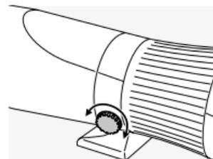
• A rögzítőcsavart balra (az óramutató járásával ellentétes irányban) elfordítva kioldhatja a rögzített helyzetben lévő állványgyűrűt.
