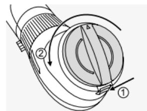
Da biste uklonili poklopac, pomerite mehanizam za zaključavanje okulara nadole i okrenite zaštitni poklopac nalevo (u smeru suprotnom od kretanja kazaljke na satu).
