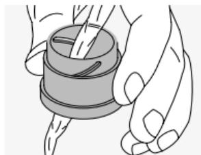
Ohišje najbolje očistite z mehko, vlažno krpo (ne uporabljajte krpe za čiščenje leč).
