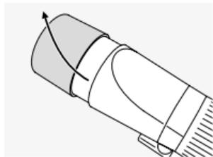
Встроенная выдвижная солнцезащитная бленда защищает наблюдателя от яркого света, а также предохраняет объектив от попадания на него капель дождя. Бленда устанавливается и убирается легким вращением. В рабочем и не рабочем положении бленда фиксируется. Защитную крышку объектива можно устанавливать даже, когда выдвинута бленда.
