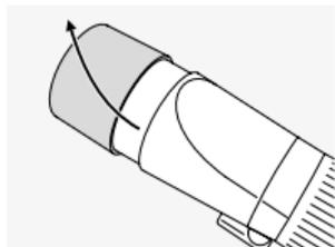
Vgrajena zložljiva sončna zaščita preprečuje motečo stransko svetlobo in ščiti lečo objektiva pred dežjem.
