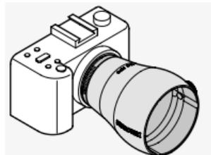
A SWAROVSKI OPTIK AT és ST 80 teleszkópok szemlencsái mechanikusan illeszkednek a fő ATS/STS és ATM/STM 65/80 testek bajonettzárjába. A legjobb optikai képkalkotás azonban az új sorozat használatával biztosítható. A SWAROVSKI OPTIK digiszkópos adaptereinek segítségével teleszkópját teleobjektívvé alakíthatja.
