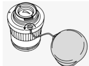
Zaščitni pokrovček okularja je z vrvico pritrjen na okular. Če z izvijačem razrahljate vijak na okularju, lahko vrvico in pokrovček odstranite z okularja. Vijak po tem ponovno vstavite.
