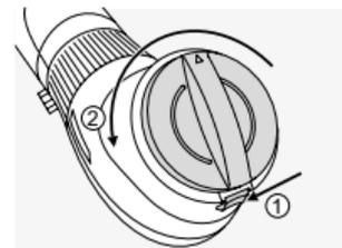
Za odstranitev pokrova pomaknite zaklepni mehanizem okularja navzdol in zaščitni pokrov zavrtite v levo (v nasprotni smeri urinega kazalca).
