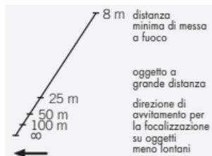
La sezione estraibile è provvista di scala per individuare rapidamente la messa a fuoco ideale in base alla distanza dell'oggetto osservato.
