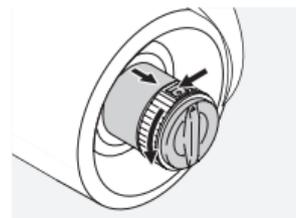
Um den Deckel abzunehmen, ziehen Sie den Auszug heraus, schieben die Okularverriegelung am Grundkörper nach unten und drehen den Bajonett-Schutzdeckel nach links (gegen den Uhrzeigersinn).
