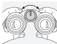
Otáčením zaostřovacího prstence můžete nastavit ostrost každého objektu od nejmenší vzdálenosti (viz technická data) po nekonečno. Při nastavení na nekonečno směřuje výstupek na zaostřovacím prstenci nahoru.
