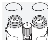
**Pos. B:** Kiindulási pozíció szemüveggel: Fordítsa be minden kifordítható szemkagylót egészen az ütközőig, az óramutató járásának megfelelő irányban.
