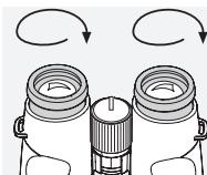
Pol. B: Izlazna pozicija s naočalam: Zavijte obje očne školjke u smjeru kazaljke na satu sve do graničnika.
