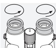
Pol. A: Izlazna pozicija bez naočala: Očne školjke odvijte do kraja okrećući ih u smjeru suprotnom od smjera kazaljke na satu.
