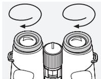
**Pos. C bzw. D:** Alternative Positionen bzw. Zwischenstufen für Brillenträger sowie nicht Brillenträger.
