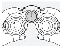
Ruotando la rotella de focalizzazione Le sarà possibile ottenere un'immagine nitida di qualsiasi oggetto posto ad una distanza ridotta (vedi scheda tecnica) fino all'infinito.
