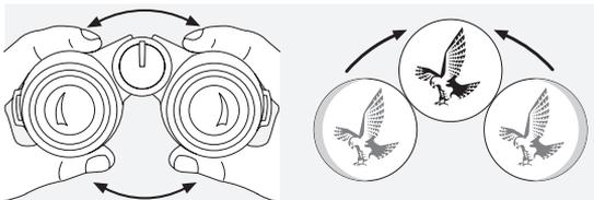
Para obtener una imagen redonda y única, debe abrir los binoculares hasta la posición en que deje de apreciar sombras molestas.
