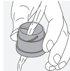
**Suojakotelon puhdistus.** Käytä toimitukseen kuuluvaa saippua- ja harjasarjaa. Sulje okulaari- ja objektiivisuoja. Kostuta harja ja puhdista kotelo varovasti levittämällä saippuaa pyörivin liikkein. Huuhtelee kiikarit puhtaalla vedellä ja kuivaa huolellisesti.
