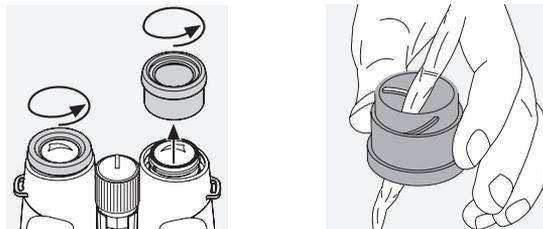
**De behuizing reinigen.** Gebruik hiervoor de meegeleverde zeep en borstelset. Plaats de beschermkappen op de oculairen en objectieven. Maak het borsteltje nat en breng de zeep met ronddraaiende bewegingen aan om de behuizing zachtjes te
