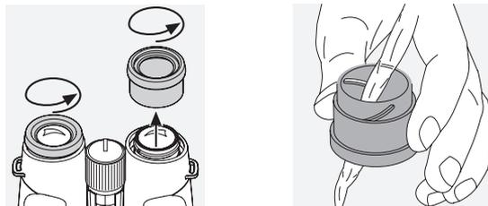
**Reinigung Gehäuseschutz.** Verwenden Sie dafür das beiliegende Soap & Brush-Kit. Schließen Sie Okular und Objektiv mit den Schutzabdeckungen. Nach Befeuchten der Bürste können Sie so die Seife in kreisenden Bewegungen aufschäumen.
