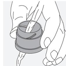
**Rengöring av skyddshöljet.** Använd den medföljande tvål- och borstsatsen. Stäng okularets och objektivets skydd. Fukta borsten och applicera tvålen med cirkelrörelser för att försiktigt rengöra höljet. Skölj kikaren med rent vatten och torka den
