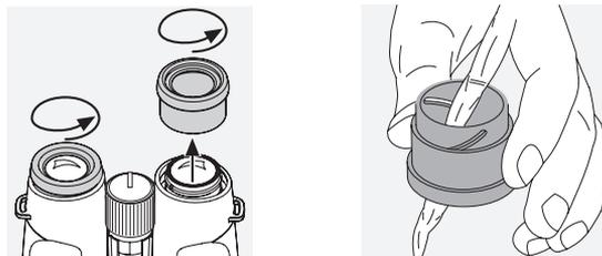
**Pulizia corpo del binocolo.** Utilizzate il kit detergente e spazzola (in dotazione). Chiudete gli obiettivi e gli oculari con le apposite coperture. Inumidite la spazzola e applicate il detergente con movimenti circolari per pulire delicatamente
