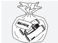
Lorsque les jumelles sont mouillées, il faut au préalable les sécher. Dans les zones tropicales ou dans des régions où règne une forte humidité ambiante, il vaut mieux entreposer vos jumelles dans un étui étanche à l'air doté d'un produit absorbant l'humidité (du type Silicagel).
