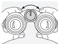
Ved at dreje på fokuseringshjulet kan du stille skarpt på et ethvert objekt fra den korteste indstillingsafstand (se det tekniske datablad) til uendeligt. Ved uendeligt peger fokuseringshjulets lille næse opad.
