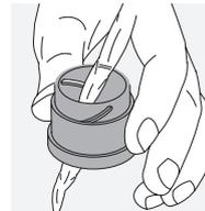
**Очистка корпуса.** Используйте набор из мыла и щетки (входит в комплект поставки). Закройте крышками окуляры и объективы. Смочите щетку, намыльте ее и протрите корпус круговыми движениями для бережной очистки. Промойте бинокль чистой водой и тщательно высушите. Если оптика стала влажной, протрите ее насухо чистой тканью, чтобы не поцарапать. Хорошо промойте щетку и высушите набор из мыла и щетки.
