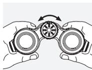
Durch Drehen des Fokussierades können Sie jedes Objekt von der kürzesten Einstellentfernung (siehe technisches Datenblatt) bis unendlich scharf stellen.
