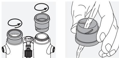
**Suojakotelon puhdistus.** Käytä toimitukseen kuuluvaa saippuaja harjasarjaa. Sulje okulaari- ja objektiivisuojat. Kostuta harja ja puhdistakotelo varovasti levittämällä saippuua pyöriin liikkein. Huuhtelee kiikarit puhtaalla vedellä ja kuivaa huolellisesti. Jos optiikka kastuu, painele kuivaksi puhtaalla liinalla, jotta optiikka ei naarmuunnu. Huuhtelee harja perusteellisesti ja jätä saippua-ja harjasarja kuivumaan.
