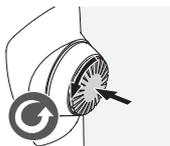
Вдавить кнопку внутрь и повернуть ее против часовой стрелки (90°).
