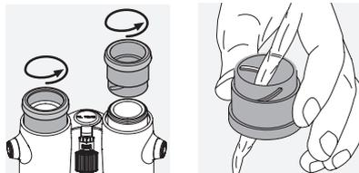
**De behuizing reinigen.** Gebruik hiervoor de meegeleverde zeep en borstelset. Plaats de beschermkappen op de oculairs en objectieven. Maak het borsteltje nat en breng de zeep met ronddraaiende bewegingen aan om de behuizing zachtjes te reinigen. Spoel de verrekijker af met schoon water en droog voorzichtig af. Als het optische systeem nat wordt, dep het dan droog met een schone doek om krassen te voorkomen. Spoel het borsteltje grondig schoon en laat de zeep en borstelset drogen.
