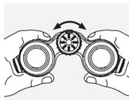
Genom att vrida fokuseringsringen kan du ställa in skärpan på föremål på mycket nära håll (se tekniska data) och upp till oändligt.
