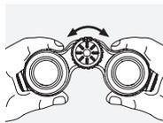
Ved at dreje på fokuseringshjulet kan du stille skarpt på et ethvert objekt fra den korteste indstillingsafstand (se det tekniske datablad) til uendeligt.
