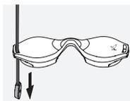
Om de oculairbeschermkap te bevestigen, trekt u eerst de riem door de lus van het deksel.
