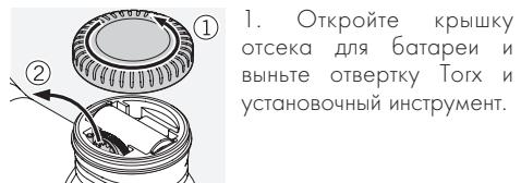
1. Откройте крышку отсека для батареи и выньте отвертку Torx и установочный инструмент.
