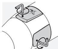
2. I cappucci per la regolazione laterale e dell'altezza possono essere svitati con il cacciavite Torx (TX 6) in dotazione. È dunque possibile procedere alla regolazione laterale e dell'altezza con l'utensile di regolazione o l'utensile di regolazione grande in dotazione (vedere punto 1. "Descrizione", posizione 15).
