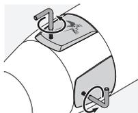
2. Locken på höjd- och sidojusteringen kan skruvas av med den medföljande torx-skruvmejsel (TX 6). Du kan sedan justera höjden och sidorna med inställningsverktyget eller det stora inställningsverktyget (se punkt 1. "Översikt", position 1.5).
