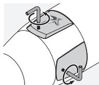
2. Крышки механизмов коррекции по высоте и боковой коррекции можно открыть с использованием отвертки Torx (TX 6), входящей в комплект поставки. Затем можно выполнить коррекцию по вертикали и горизонтали с использованием установочного инструмента или большого установочного инструмента, входящего в комплект поставки (см. п. 1. «Обзор», позиция 15).
