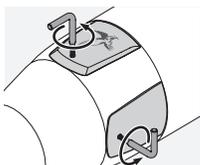
2. Dækslerne på højde- og sideindstillingen kan skrues af med den medfølgende torxskruetrækker (TX 6). Du kan derefter justere højde- og sideindstillingen med indstillingsværktøjet eller det store indstillingsværktøj, der medfølger (se punkt 1. "Oversigt", position 15).
