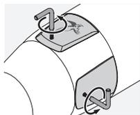
2. Las tapas de los reglajes vertical y horizontal se pueden abrir con el destornillador tipo Torx (TX 6) suministrado. Una vez abiertas, puede ajustar el reglaje vertical y horizontal con la herramienta de ajuste o la herramienta de ajuste grande proporcionada (véase Punto 1. "Descripción", posición 15).
