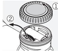
1. Open het batterijdekseel en verwijder de torx-schroevendraaier en het gereedschap.
