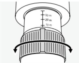
På okularet er der en afstandsskala. Den hjælper dig med hurtigt at indstille teleskopet til den ønskede afstand. Ligeledes gør skalaen det muligt at foretage en mere eller præcis afstandsbedømmelse.
