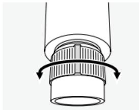
Durch Drehen des Okulars können Sie jedes Objekt in einer Entfernung von 10 m bis unendlich scharf stellen. Bei unendlich zeigt die Nase am Okular nach oben.
