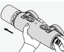
Beskyttelseshylsterets størrelse er perfekt dimensioneret til at passe dit teleskop, en svag vedhængende-effekt mellem beskyttelseshylsterets og det udtrækkelige teleskop kan forekomme gennem tiden. Afmontering af beskyttelseshylsteret kan bedst opnås ved at holde teleskopet med den ene hånd og skubbe det udtrækkelige teleskop fra okularrets side fremad og ud af beskyttelseshylsteret.
