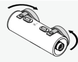
Il cannocchiale da osservazione è custodito in un involucro esterno. Durante l'osservazione i coperchi dell'involucro esterno possono essere messi da un lato senza aprire il pulsante a pressione. Alternativamente si può anche aprire il pulsante a pressione, mettere i coperchi lateralmente rispetto al corpo principale e chiudere di nuovo il pulsante a pressione.
