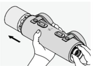
Como la funda de campo se ajusta perfectamente a su telescopio puede aparecer un ligero efecto de adherencia entre la funda y el telescopio. Podemos retirar la funda de campo más fácilmente si sujetamos el telescopio con una mano y lo apretamos hacia delante desde el lado del ocular hasta retirar la funda de campo.
