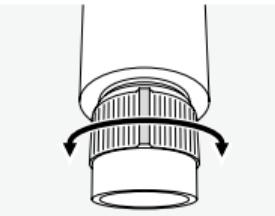
Al girar el ocular, puede enfocar nítidamente cualquier objeto desde una distancia de 10 m hasta el infinito. En la posición «infinito» la muesca del ocular se halla en la parte superior.
