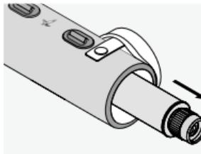
Houd de telescoop bij het basisinstrument en het oculair vast. Trek het uittrekbare gedeelte er tot de aanslag volledig uit.
