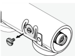
la pièce de raccord au trépied est équipée d'un filet de raccord de 3/8" UNC. La vis de recouvrement intégrée réduit le filet de raccord à 1/4" UNC. La longue-vue d'observation s'adapte ainsi à tous les trépieds usuels.
