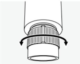
Door draaien van het oculair kunt u elk object op een afstand van 10 m tot oneindig scherp stellen. Bij oneindig wijst het neusje op het oculair naar boven.
