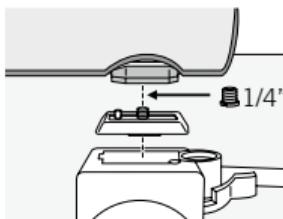
De statiefvoet heeft een aansluitschroefdraad van 3/8" UNC. De aangebrachte opzetschroef reduceert de aansluitschroefdraad tot 1/4" UNC. Hierdoor past de telescoop op elk gangbaar statief.
