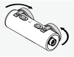
La longue-vue d'observation est rangée dans un étui d'utilisation. Les bonnettes de l'étui d'utilisation peuvent être coulissées sur le côté - sans ouverture des boutons pression - pour l'observation. Alternativement, vous pouvez également ouvrir un bouton pression, placer les bonnettes sur le côté contre le corps de la longue-vue et refermer le bouton pression.
