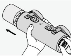
Omdat de stay-on case perfect op maat gemaakt is van uw telescoop, kan er met de tijd een klein hechtingseffect ontstaan tussen de stay-on case en uw telescoop. U kan de stay-on case het best verwijderen door de telescoop in de ene hand te houden en met de andere hand het oculairgedeelte vooruit te duwen, uit de stay-on case.
