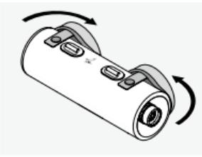
Зрительная труба помещается в защитный чехол. Во время наблюдения крышки защитного чехла можно отодвигать в сторону, не открывая при этом кнопки. Другой вариант – открыть кнопку, сложить с ее помощью крышку по бокам корпуса, а затем снова ее спрятать.
