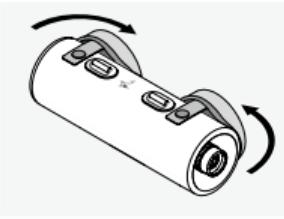
El telescopio está guardado en una funda permanente. Las tapas se deslizan hacia un lado sin necesidad de abrir los pulsadores. También puede abrir un pulsador, colocar las tapas en el lateral del cuerpo principal y volver a cerrar el pulsador.
