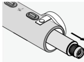
Hold fast i teleskopet på grunddelen og okularet. Træk udtrækket helt ud indtil anslaget.
