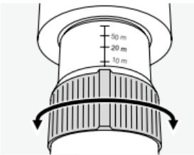
Op het oculair bevindt zich een afstandsschaal. Hierdoor is het eenvoudiger snel op de gewenste afstand in te stellen. Bovendien maak de schaal een grove schatting van de afstand mogelijk.
