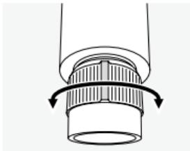
Girando l'oculare potete mettere a fuoco qualsiasi oggetto ad una distanza da 10 m fino all'infinito.
