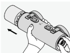
Då skyddshöljet är skräddarsytt för att passa tubkikaren perfekt, kan det ibland vara besvärligt att få ut den ur höljet. Bästa sättet att få ut en tubkikare ur dess skyddshölje är genom att med en hand hålla i tubkikaren och samtidigt trycka ut den från okularsidan.
