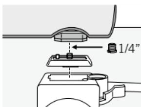
Il piedino del cannocchiale da osservazione si fissa ad un attacco filettato da  $3/8''$  UNC. La vite inserita riduce l'attacco filettato a  $1/4''$  UNC. Pertanto il cannocchiale da osservazione è adatto per ogni treppiede convenzionale.
