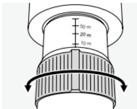
L'oculare è provvisto di scala per individuare rapidamente la messa a fuoco ideale in base alla distanza dell'oggetto osservato.
