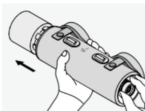
Durch das passgenaue Design der Schutzhülle kann nach einiger Zeit ein leichter Haftungseffekt zwischen Schutzhülle und Teleskop entstehen. Das Abnehmen der Schutzhülle gelingt am einfachsten, indem Sie mit einer Hand das Okular umfassen und das Teleskop nach vorne aus der Schutzhülle drücken, während die andere Hand außen an der Schutzhülle dagegenhält.
