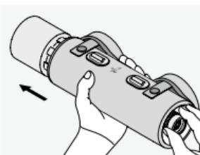
Так как защитный чехол идеально соответствует размеру корпуса Вашей зрительной трубы, поэтому небольшой эффект слипания защитного чехла с корпусом может произойти с течением времени. Удаление защитного чехла может быть произведено путем удержания зрительной трубы одной рукой и нажатием на корпус, толкая со стороны окуляра другой рукой.
