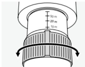
Am Okular befindet sich eine Entfernungsskala. Sie hilft Ihnen, rasch auf die gewünschte Entfernung einzustellen. Ebenso ermöglicht die Skala eine grobe Abschätzung der Entfernung.
