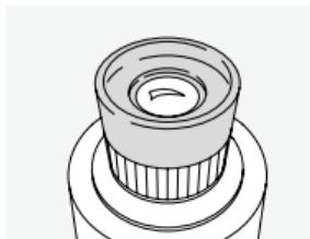
Door omplooien van de oogkleppen heeft ook een brildrager het grote gezichtsveld optimaal ter beschikking. U kunt de oogkleppen eraf schroeven om ze te reinigen of te vervangen.
