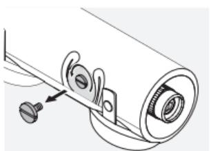
De statiefvoet heeft een aansluitschroefdraad van 3/8" UNC. De aangebrachte opzetschroef reduceert de aansluitschroefdraad tot 1/4" UNC. Hierdoor past de telescoop op elk gangbaar statief.
