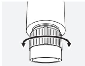
Girando l'oculare potete mettere a fuoco qualsiasi oggetto ad una distanza da 10 m fino all'infinito. Nella posizione d'infinito la tacca dell'oculare è rivolta verso alto.
