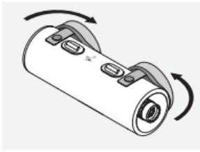
Teleskopet er placeret i et beskyttelseshylster. Dækslerne på beskyttelseshylsteret kan åbnes til inspektion - uden at åbne trykknapperne. Alternativt kan du lukke en tryknap op, lægge kapperne an mod grundstykket ved siden af og lukke trykknappen igen.
