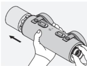
Beskyttelseshylsterets størrelse er perfekt dimensioneret til at passe dit teleskop, en svag vedhængende-effekt mellem beskyttelseshylsterets og det udtrækkelige teleskop kan forekomme gennem tiden. Afmontering af beskyttelseshylsteret kan bedst opnås ved at holde teleskopet med den ene hånd og skubbe det udtrækkelige teleskop fra okularets side fremad og ud af beskyttelseshylsteret.
