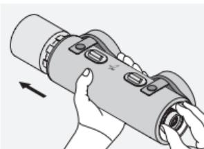
Так как защитный чехол идеально соответствует размеру корпуса Вашей зрительной трубы, поэтому небольшой эффект слипания защитного чехла с корпусом может произойти с течением времени. Удаление защитного чехла может быть произведено путем удержания зрительной трубы одной рукой и нажатием на корпус, толкая со стороны окуляра другой рукой.
