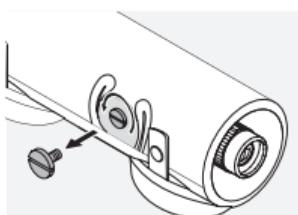
Stativfoden har et påskruningsgevind på 3/8" UNC. Den indsatte skrue reducerer påskruningsgevindet til 1/4" UNC. Teleskopet passer derfor til alle gængse stativer.
