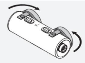
El telescopio está guardado en una funda permanente. Las tapas se deslizan por la funda permanente sin necesidad de abrir los pulsadores. También puede abrir un pulsador, colocar las tapas en el lateral del cuerpo principal y volver a cerrar el pulsador.
