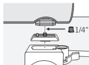
В месте крепления к штативу находится отверстие с резьбой 3/8" UNC. Использование переходника позволяет перейти на резьбу 1/4" UNC. Таким образом, зрительную трубу можно устанавливать на любой штатив.
