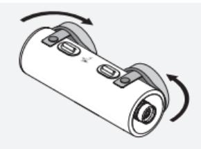
Зрительная труба помещается в защитный чехол. Во время наблюдения крышки защитного чехла можно отодвигать в сторону, не открывая при этом кнопки. Другой вариант – открыть кнопку, сложить с ее помощью крышку по бокам корпуса, а затем снова ее спрятать.
