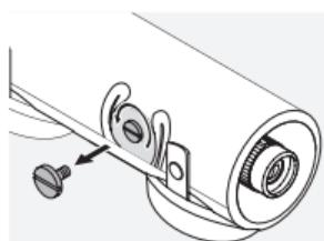
El pie del telescopio dispone de una rosca de 3/8" UNC. El tornillo adaptador reduce la rosca a 1/4" UNC de forma que el telescopio puede emplearse con cualquier trípode.
