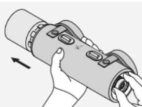
Durch das passgenaue Design der Schutzhülle kann nach einiger Zeit ein leichter Haftungseffekt zwischen Schutzhülle und Teleskop entstehen. Das Abnehmen der Schutzhülle gelingt am einfachsten, indem Sie mit einer Hand das Okular umfassen und das Teleskop nach vorne aus der Schutzhülle drücken, während die andere Hand außen an der Schutzhülle dagegenhält.
