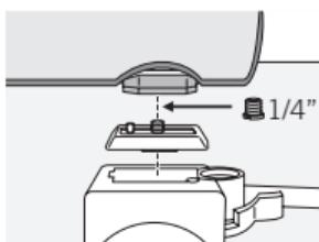
Der Stativfuß verfügt über ein Anschlussgewinde von  $3/8"$  UNC. Die eingesetzte Überschraube reduziert das Anschlussgewinde auf  $1/4"$  UNC. Das Teleskop passt somit auf jedes gängige Stativ.
