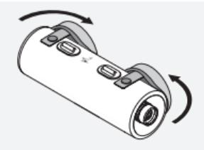
Das Teleskop befindet sich in einer Schutzhülle. Die Kappen dieser können zum Beobachten - ohne Öffnen der Druckknöpfe - auf die Seite geschoben werden. Alternativ können Sie auch einen Druckknopf aufmachen, die Kappen seitlich am Grundkörper anlegen und den Druckknopf wieder schließen.
