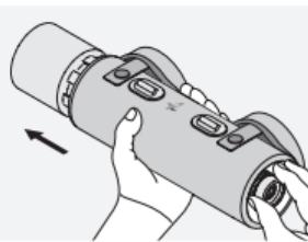
Como la funda de campo se ajusta perfectamente a su telescopio puede aparecer un ligero efecto de adherencia entre la funda y el telescopio. Podemos retirar la funda de campo más fácilmente si sujetamos el telescopio con una mano y lo apretamos hacia delante desde el lado del ocular hasta retirar la funda de campo.
