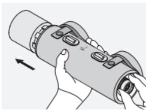
Beskyttelseshylsterets størrelse er perfekt dimensioneret til at passe dit teleskop, en svag vedhængende-effekt mellem beskyttelseshylsterets og det udtrækkelige teleskop kan forekomme gennem tiden. Afmontering af beskyttelseshylsteret kan bedst opnås ved at holde teleskopet med den ene hånd og skubbe det udtrækkelige teleskop fra okularets side fremad og ud af beskyttelseshylsteret.
