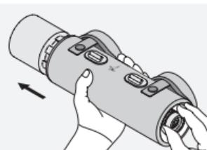
Då skyddshöljet är skräddarsytt för att passa tubkikaren perfekt, kan det ibland vara besvärligt att få ut den ur höljet. Bästa sättet att få ut en tubkikare ur dess skyddshölje är genom att med en hand hålla i tubkikaren och samtidigt trycka ut den från okularsidan.
