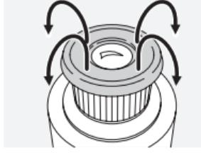
Durch Stülpen der Augenmuscheln steht auch dem Brillenträger das gesamte Sehfeld optimal zur Verfügung. Zur Reinigung oder zum Austausch können Sie die Augenmuscheln abschrauben.
