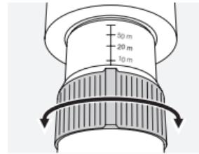
L'oculare è provvisto di scala per individuare rapidamente la messa a fuoco ideale in base alla distanza dell'oggetto osservato.
