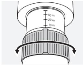
Op het oculair bevindt zich een afstandsschaal. Hierdoor is het eenvoudiger snel op de gewenste afstand in te stellen. Bovendien maak de schaal een grove schatting van de afstand mogelijk.
