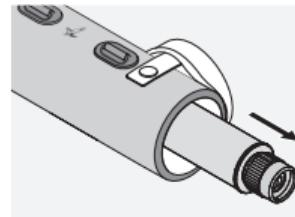
Возьмитесь одной рукой за корпус зрительной трубы вблизи объектива, другой рукой – за окуляр. Вытяните внутреннюю трубу до упора.
