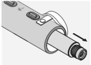
Houd de telescoop bij het basisinstrument en het oculair vast. Trek het uittrekbare gedeelte er tot de aanslag volledig uit.
