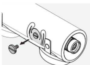
Stativfoden har et påskruningsgevind på 3/8" UNC. Den indsatte skrue reducerer påskruningsgevindet til 1/4" UNC. Teleskopet passer derfor til alle gængse stativer.
