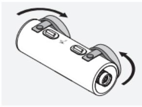
Teleskopet er placeret i et beskyttelseshylster. Dækslerne på beskyttelseshylsteret kan åbnes til inspektion - uden at åbne trykknapperne. Alternativt kan du lukke en tryknap op, lægge kapperne an mod grundstykket ved siden af og lukke trykknappen igen.
