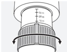
På okularet er der en afstandsskala. Den hjælper dig med hurtigt at indstille teleskopet til den ønskede afstand. Ligeledes gør skalaen det muligt at foretage en mere eller præcis afstandsbedømmelse.
