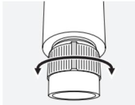
Door draaien van het oculair kunt u elk object op een afstand van 10 m tot oneindig scherp stellen. Bij oneindig wijst het neusje op het oculair naar boven.
