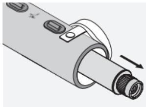
Afferrate il cannocchiale da osservazione ponendo una mano sul corpo principale e l'altra sul lato dell'oculare. Fate uscire completamente la sezione estraibile fino all'arresto.
