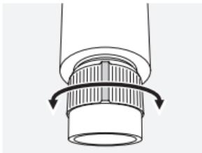
Al girar el ocular, puede enfocar nítidamente cualquier objeto desde una distancia de 10 m hasta el infinito. En la posición «infinito» la muesca del ocular se halla en la parte superior.
