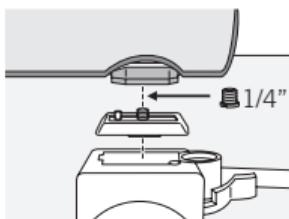
Der Stativfuß verfügt über ein Anschlussgewinde von  $3/8"$  UNC. Die eingesetzte Überschraube reduziert das Anschlussgewinde auf  $1/4"$  UNC. Das Teleskop passt somit auf jedes gängige Stativ.
