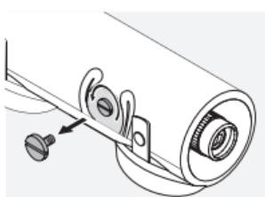
Il piedino del cannocchiale da osservazione si fissa ad un attacco filettato da  $3/8''$  UNC. La vite inserita riduce l'attacco filettato a  $1/4''$  UNC. Pertanto il cannocchiale da osservazione è adatto per ogni treppiede convenzionale.
