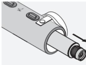
Halten Sie das Teleskop am Grundkörper und am Okular fest. Ziehen Sie den Auszug bis zum Anschlag vollständig heraus.
