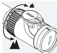
Ved at dreje forstørrelsesindstillingsringen 180° kan den ønskede forstørrelse indstilles trinløst. Skalaen på indstillingsringen muliggør en nem og komfortabel aflæsning af indstillingen.
