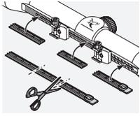
De bijgevoegde afdekking dient ter bescherming van de open railgedeelten. Ze kan op de benodigde grootte worden afgeknipt en manueel op de rail worden gedrukt.
