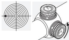
Поверните ролик коррекции по горизонтали в направлении стрелки R - против часовой стрелки.
