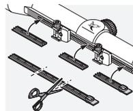
La couvre-rail ci-joint sert à protéger les parties à rail libres. Sa conception s'adapte à la dimension requise et il s'enfonce dans le rail par simple pression de la main.
