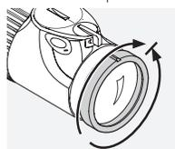
Drehen Sie erst den Dioptrienstellring ganz nach links (gegen den Uhrzeigersinn) und dann nach rechts, bis das Absehen die optimale Schärfe zeigt. Die Stellbereiche sind von den einzelnen Modellen abhängig. Bitte lesen Sie hierzu im beigefügten technischen Datenblatt.
