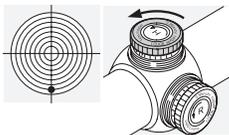
Gire la rueda estriada de reglaje del ajuste en altura en el sentido de la flecha H, en sentido contrario al de las agujas del reloj.
