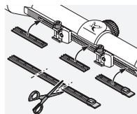
La tapa siguiente sirve para la protección de las piezas del carril que van sueltas. Puede ser cortada y adaptada a las dimensiones necesarias, introduciéndose manualmente en el carril correspondiente.
