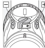
In dem von Ihnen gewählten Modus können Sie nun die Helligkeit mittels der +/- Taste einstellen. Zum schnellen Finden der optimalen Helligkeit können Sie die Taste gedrückt halten (Dauerimpuls). Durch einmaliges Drücken der Tasten (Einzelimpuls) nehmen Sie die Feinjustierung vor.
