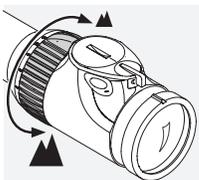
Girando l'anello di regolazione dell'ingrandimento di 180° potete regolare l'ingrandimento a piacimento. La scala sull'anello di regolazione consente una facile e comoda lettura della regolazione.
