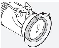
Girate dapprima il compensatore di diottrie completamente verso sinistra (in senso antiorario) e poi verso destra, finché il reticolo non mostri la nitidezza ottimale.
