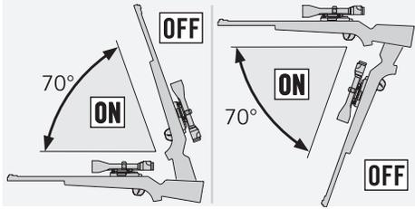
El visor también se desconecta con un vuelco lateral de más de  $30^\circ$  (por ejemplo, cuando el arma se coloca sobre las piernas).
