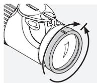
Tournez la bague de réglage de la dioptrie entièrement vers la gauche (dans le sens horaire inverse) puis vers la droite, jusqu'à ce que le réticule soit le plus net possible.
