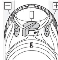
I modusen, som du har valgt, kan du indstille lysstyrken vha. knappen +/- . Du kan holde knappen nede (konstant impuls) for hurtigt at finde den optimale lysstyrke. Ved at trykke en enkelt gang på knappen (enkelt impuls) foretages en finjustering.
