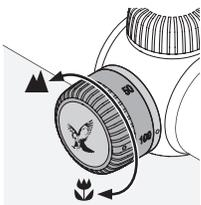
Con la torre de paralaje podrá ajustar la nitidez óptica para cualquier distancia al objetivo y evitar el error de puntería por paralaje.
