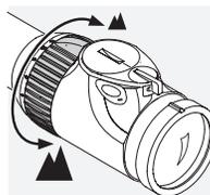
Durch Drehen des Vergrößerungsstellrings um bis zu 180° können Sie die gewünschte Vergrößerung stufenlos einstellen. Die Skala am Stellring ermöglicht ein einfaches und komfortables Ablesen der Einstellung. Zur besseren Orientierung besitzt der weiche, gerippte Stellringüberzug eine Nase.
