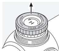
1. Entkoppeln Sie zuerst den Rändelknopf durch Zug nach oben. In dieser Stellung wird beim Verdrehen des Rändelknopfes das Absehen nicht verstellt.
