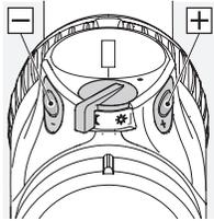
В выбранном режиме имеется возможность регулирования яркости с помощью клавиш +/- . Для быстрого поиска оптимального режима подсветки удерживайте клавишу в нажатом положении (постоянный импульс). Точная настройка осуществляется кратким нажатием на клавишу (одиночный импульс).
