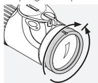
Drej først dioptri-indstillingsringen helt til venstre (mod uret) og derefter til højre, indtil sigtet viser optimal skarphed.
