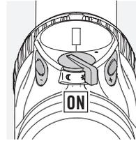
Sie können die SWAROLIGHT Funktion deaktivieren indem Sie die +/- Tasten gleichzeitig 5 Sekunden gedrückt halten. Ein zweimaliges Blinken des Leuchtpunktes bestätigt die Umschaltung. Durch ein
