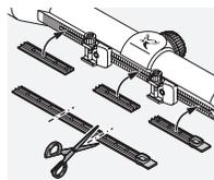
Det medlevererade skyddet, ska skydda skenornas fritt liggande delar. Det kan skäras till i passande storlek och tryckas in i skenan med handen.
