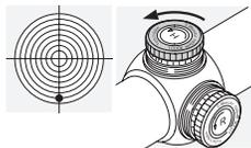
Поверните ролик коррекции по вертикали в направлении стрелки Н - против часовой стрелки.
