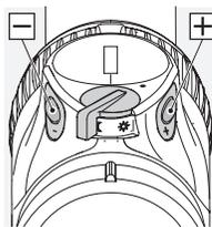
Nella modalità selezionata adesso potete regolare la luminosità premendo il tasto +/- . Per ottenere rapidamente una perfetta luminosità, potete mantenere premuto il tasto (impulso continuo). Eseguite la messa a punto premendo una volta i tasti (singolo impulso).
