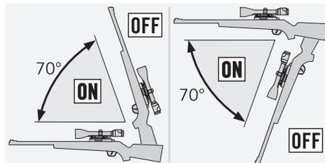
Оптический прицел также отключается при боковом уклоне более 30° (например, когда вы кладете ружье себе на ноги).
