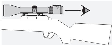
При использовании установленного на оружие прицела соблюдайте заданное расстояние между прицелом и глазом (данные в спецификации).
