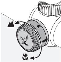
Mit dem Parallaxeturm können Sie die optimale Schärfe für jede Zielentfernung einstellen und Zielfehler durch Parallaxe vermeiden.
