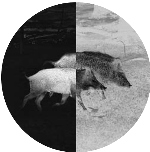
Tepelný obraz se zobrazuje ve dvou režimech: vlevo bílá tepla (bílé zdroje tepla), vpravo černá tepla (černé zdroje tepla)
